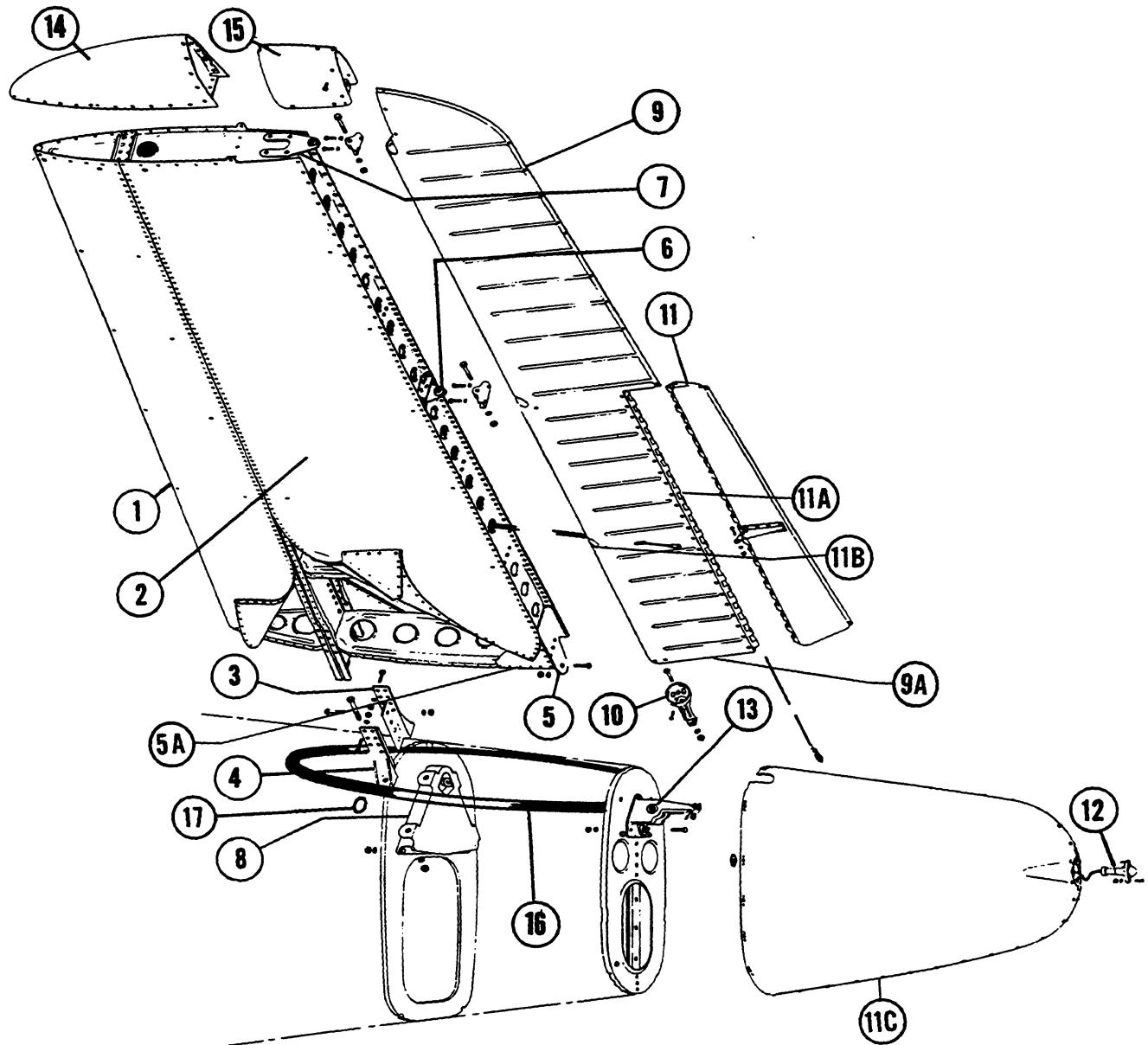
Figure 12. Empennage Group (D1 Thru D2680)
